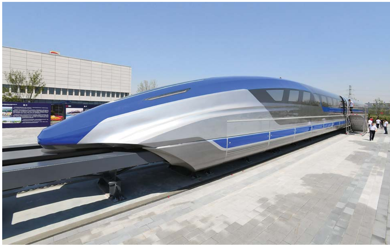
▲5月23日在青岛拍摄的我国时速600公里高速磁浮试验样车。新华社记者李紫恒摄
