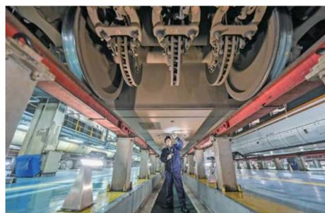
▲南京动车段南京动车所的工作人员在检查维护列车的底板螺栓(1月19日摄)。新华社记者李博摄
