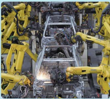
▲在宁波市北仑区吉利汽车春晚制造基地拍摄的自动化焊接线(2016年7月22日摄)。吉利汽车春晚制造基地采用全自动化焊接线,通过114台焊接机器人完成车身各部分的焊接,以保证车身制造精度的稳定。新华社记者黄宗治摄
