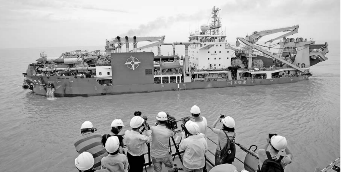
▲6月8日,由中交天津航道局投资建设,具有中国自主知识产权的亚洲最大重型自航绞吸挖泥船“天鲲号”,缓缓驶离位于江苏启东的船厂码头,开启为期3天的海试。“天鲲号”全长140米,宽27.8米,最大挖深35米,总装机功率25843千瓦,设计每小时挖泥6000立方米。新华社记者李响摄
