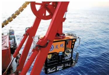
▲3月16日，“发现”号ROV深海机器人(水下缆控潜器)进行测试。为确保达到最佳工作状态，技术人员对它进行了水下1000米测试。新华社记者张建松摄
