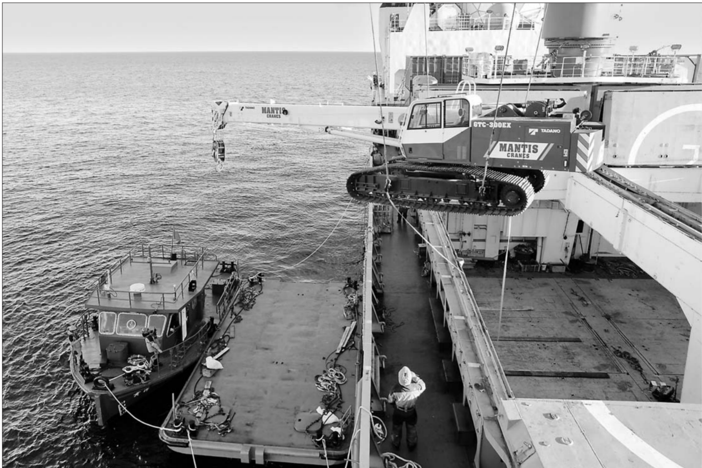
▲当地时间1月16日下午,“雪龙”号船载起重机将履带吊车吊上驳船,准备运往恩克斯堡岛。1月16日,中国第34次南极科考队成功将3台大型工程装备运上南极恩克斯堡岛。这3台大型工程装备分别为履带挖掘机、装载机和履带吊车,是用于建设中国第五个南极考察站的关键装备。这些装备最重的有28吨,无法用直升机吊运,只能用小艇和驳船从水路运到岛上。 新华社记者白国龙摄
