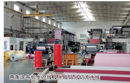
两条涂布机生产线及半成品分切流水线
