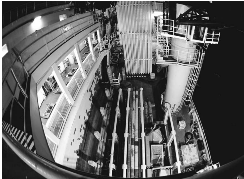
▲这是2016年1月16日拍摄的“决心”号大洋钻探船上的夜晚景象。当晚,美国、英国、中国等12国科学家参加的大洋钻探旨在打穿地球壳幔边界,过程十分艰难。进入400米后,随着钻孔越钻越深,钻孔故障频发,已损坏了3个钻头。为了尽快越过故障多发地带,“决心”号采用了力量更大的三牙轮钻头连续向下钻进而不取芯。目前钻孔深度已突破600米,并恢复了正常取芯。新华社资料照片
